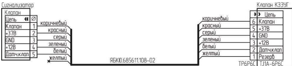
Рисунок Б.6 – Схема подключения клапана КЗЭУГ с разъемом TJ1A-6P6C.
