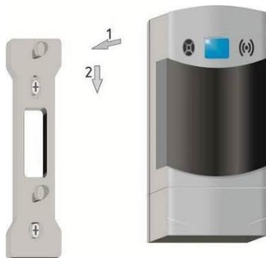
Рисунок 5 – Установка сигнализатора на монтажную панель
