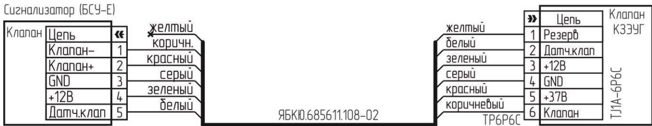
Рисунок В.2 – Схема подключения клапана КЗЭУГ с разъемом Т11А-6Р6С
